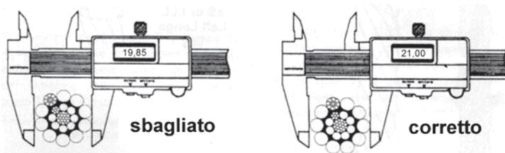
Il *diametro effettivo* di una fune è la media di 4 diametri, rilevati come segue:
