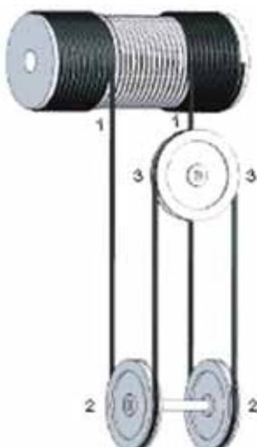
1. Nel tratto avvolto sul tamburo vanno ricercati segni di pretensionamento insufficiente, che può causare schiacciamento delle spire inferiori; di usura; e di schiacciamenti o altri danneggiamenti, specialmente nelle parti della fune a contatto con le flange, dove, negli avvolgimenti a più strati, si inverte il senso di avvolgimento
