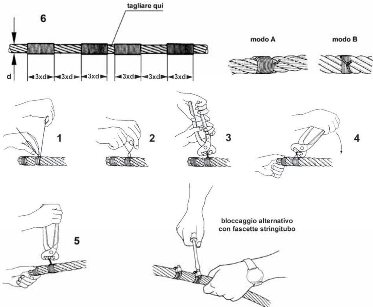
Procedura: eseguire 2 coppie di legature in filo di ferro ricotto, preferibilmente zincato (passi da 1 a 5), teso quanto possibile, lunghe 3 volte il diametro della fune e spaziate fra loro 3 volte il diametro, lasciando uno spazio pari a 2 diametri, con un minimo di 20 mm ed un massimo di 50 mm, fra le legature centrali, dove verrà tagliata la fune (passo 6).
