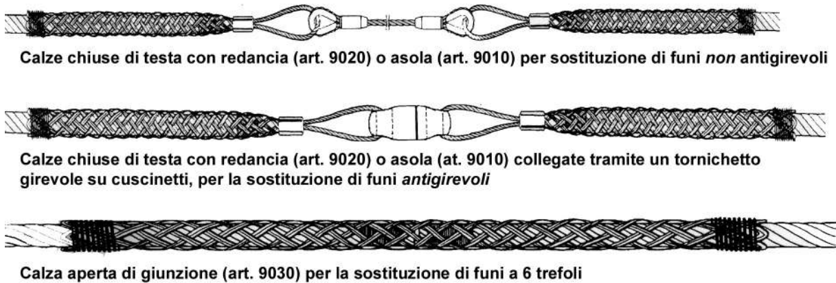
fig. 7 – utilizzo delle calze tiracavi
