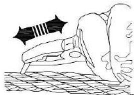
fig. 12 – rimozione di un filo rotto
