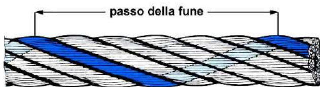
fig. 3 - passo della fune
