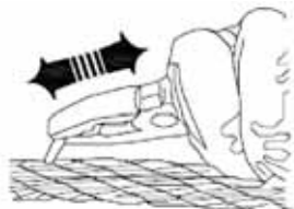
fig. 12 – rimozione di un filo rotto
